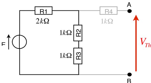
La résistance  $R_4$  n'est pas prise en compte car, la charge étant déconnectée, aucun courant ne la traverse.
