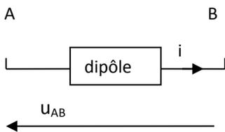
Un dipôle électrique est caractérisé par deux grandeurs électriques :
