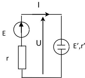
On considère un électrolyseur alimenté par une source de tension (fém  $E = 800 \text{ V}$ , résistance interne  $r = 1 \Omega$ ).
