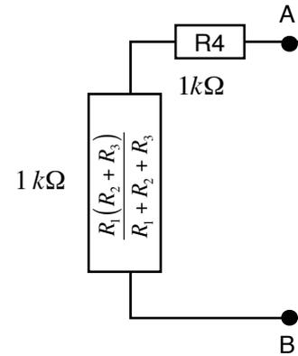
D'où au final  $R_{Th} = 2\text{ k}\Omega$
