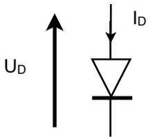
Une diode est un dipôle unidirectionnel, dont les bornes sont appelées Anode (A) et Cathode (K).
