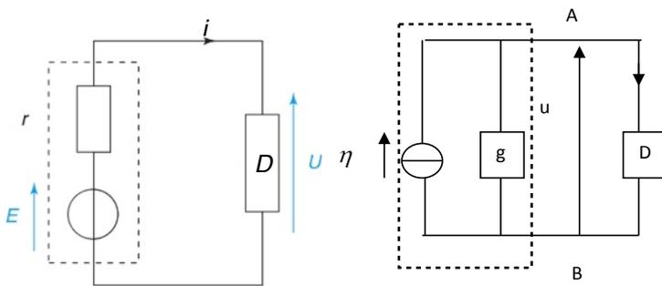
On considère un dipôle récepteur est connecté à un dipôle générateur (e,r) ou (η,g) . Il existe alors un point de fonctionnement spécifique au couplage.
