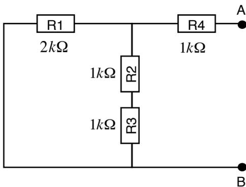
La source de tension est rendue passive, et on calcule la résistance équivalente :
