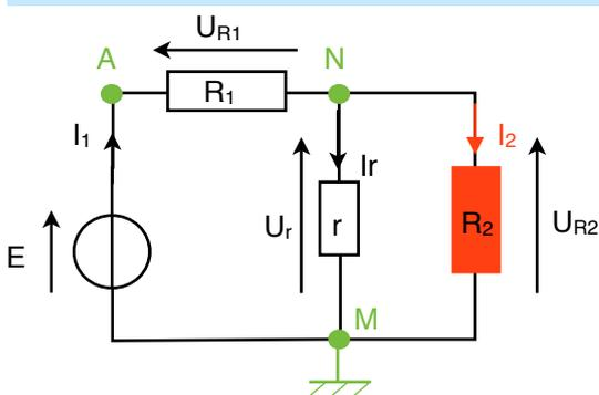
Reprenons le circuit décrit au B.1.2, et plaçons-y arbitrairement une référence de tension («masse») en M :  $V_M = 0$
