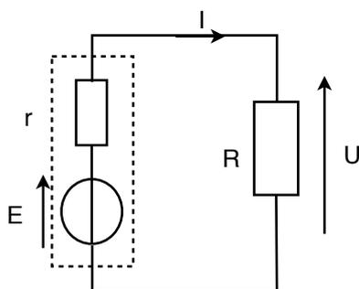
On considère un générateur de fém  $E = 10V$  et de résistance interne  $r = 5\Omega$ . Ce générateur est couplé à une résistance  $R = 5\Omega$
