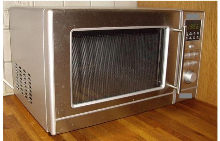
la porte d'un micro-onde est une grille métallique qui permet la fermeture de la cage de Faraday
