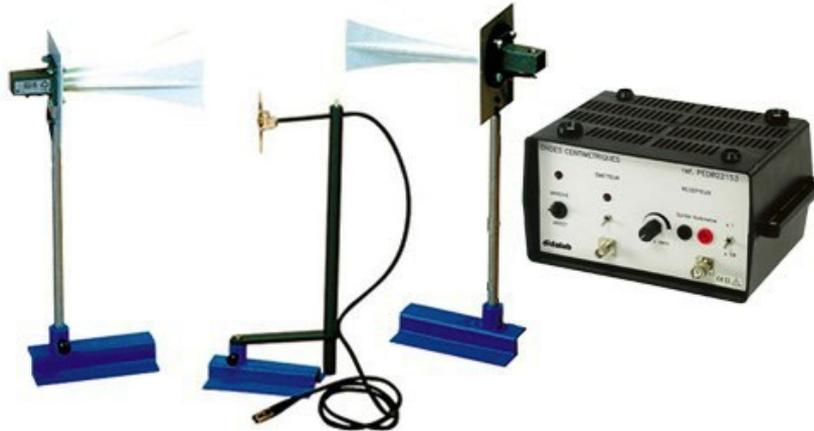
On dispose d'un émetteur électromagnétique (c'est une antenne émettrice ... à gauche sur la photo) dont on peut sélectionner la fréquence d'émission  $f_1 = 9,5 \text{ GHz}$  ou  $f_2 = 11,4 \text{ GHz}$ . On prendra  $f_2$  comme fréquence d'émission de l'onde sinusoïdale. L'onde électromagnétique émise possède les propriétés suivantes :
