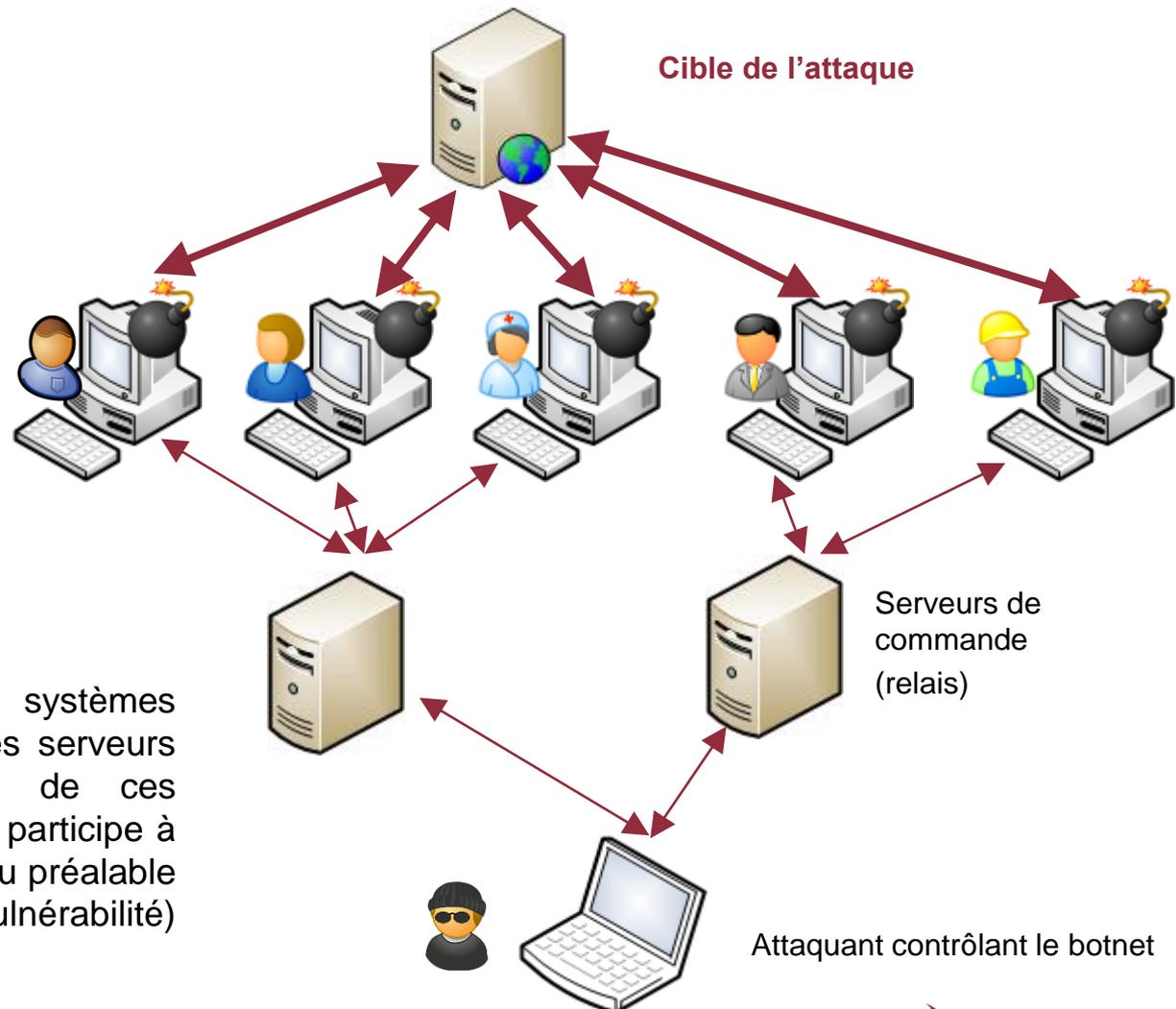
Un **botnet** est un ensemble de systèmes contrôlables par un attaquant via des serveurs de commande. Les propriétaires de ces systèmes ne savent pas que leur PC participe à un botnet (leur PC a été compromis au préalable et à leur insu via l'exploitation d'une vulnérabilité)
