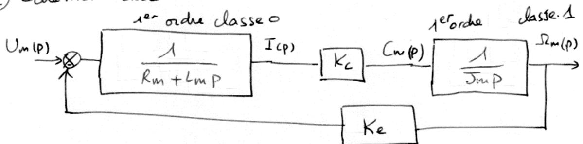
③ Fonction de transfert du moteur (système bouclé):
