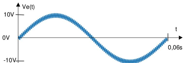
L'erreur de mesure due au bruit passe de 100% (sans le filtre) à 10% (grâce au filtre).
