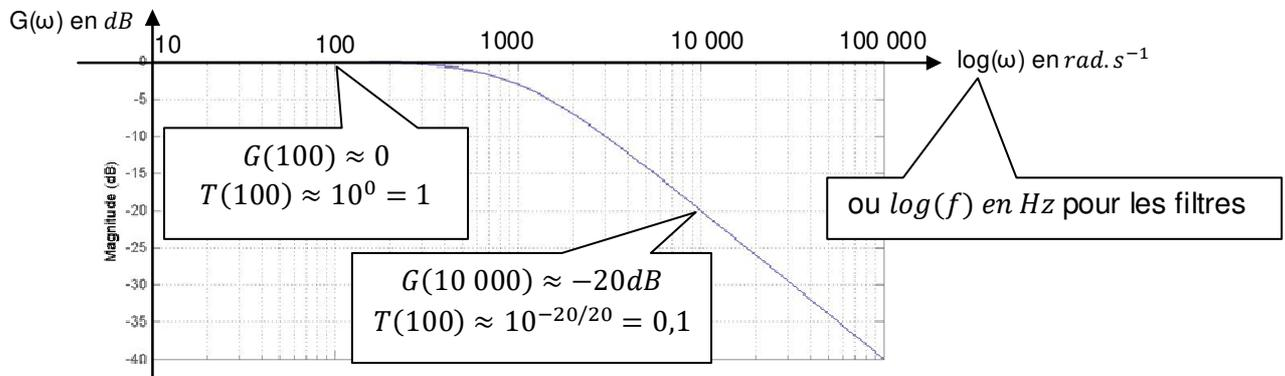
Signal mesuré de pulsation  $100 \text{ rad.s}^{-1}$  bruité par un signal de  $10\,000 \text{ rad.s}^{-1}$  de même amplitude 10 V :
