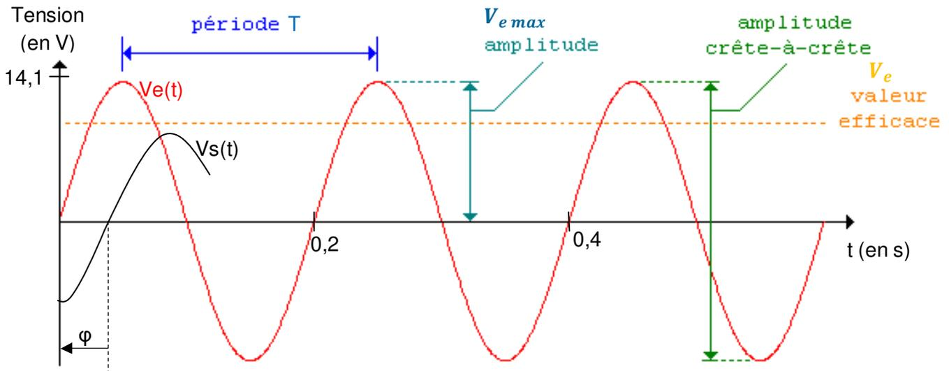
**Paramètres caractéristiques d'un signal sinusoïdal :**
