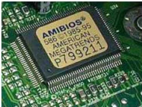
Le temps d'accès des ROM est plus lente que la RAM et la taille de stockage dépend de l'application (du Go à plusieurs To).
