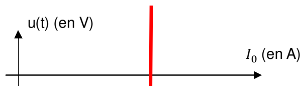
Figure 2 : Caractéristique u(i) d'une source de courant positive et constante
