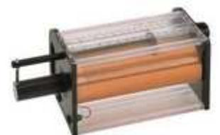
On obtient une inductance variable par déplacement du noyau (plaques métalliques) qui facilite la circulation du champ magnétique.
