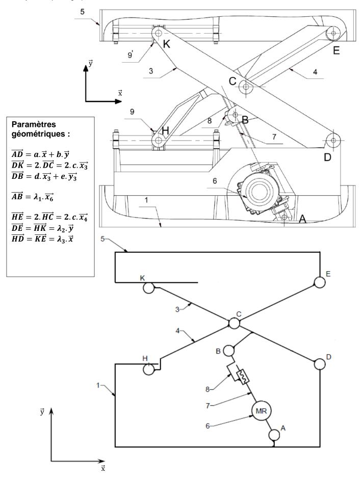
a=0,25 m, b=0,35 m , c=0,5 m, d=0,45 et e=0,15m sont fixes, imposées par le mécanisme  $\lambda_1$ ,  $\lambda_2$  et  $\lambda_3$  sont variables
