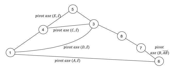
4) Identifier l'entrée et la sortie du mécanisme puis proposer une démarche permettant de déterminer une loi de mouvement (on précisera les différentes fermetures géométriques qu'il faudra résoudre).
