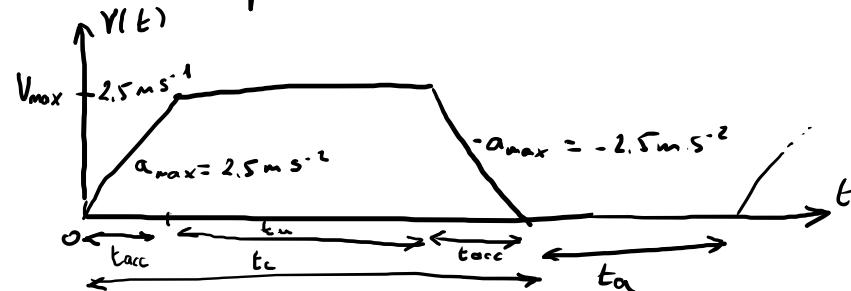
$$a_{\max} = \frac{V_{\max}}{t_{\text{acc}}} \text{ donc } t_{\text{acc}} = \frac{V_{\max}}{a_{\max}} = \frac{2,5}{2,5} = 1 \text{ s}$$
