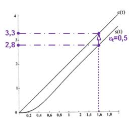
**5)** Déterminer le dépassement pour la réponse suivante. Exprimer ce dépassement en % et vérifier qu'il est inférieur à 5%. En déduire le temps de réponse t5% ainsi que le temps de montée tm.
