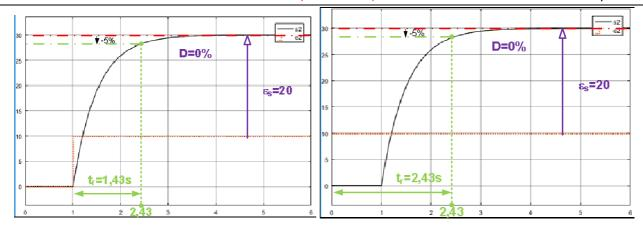
8) Déterminer  $t_{5\%}$ ,  $D_{1\%}$  et  $\epsilon s$  de la réponse suivante. Comment justifier la forme du 1 er dépassement
