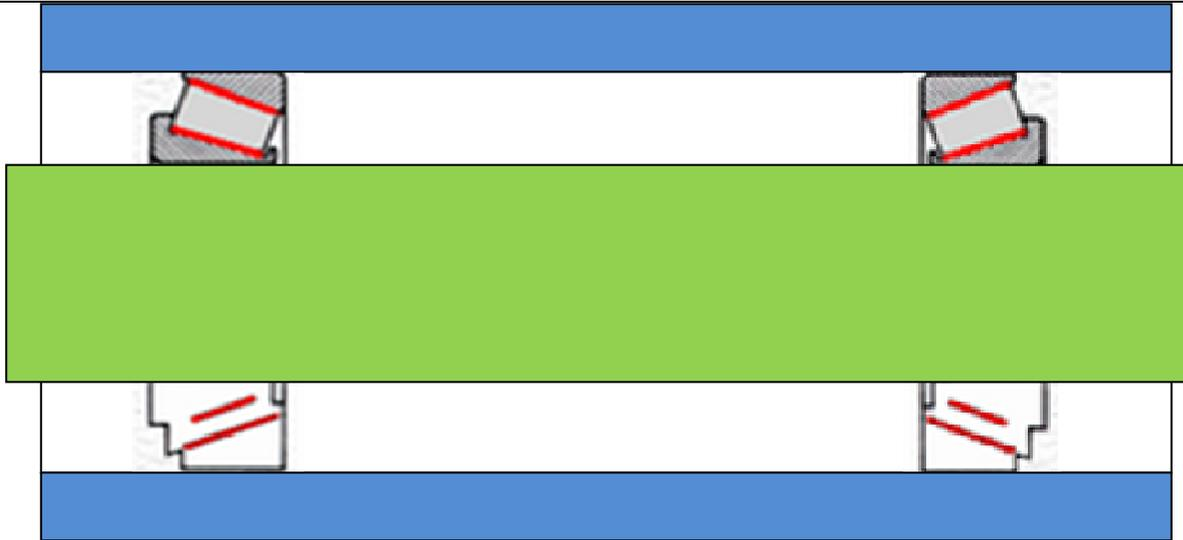
Figure 9 : Schéma du guidage (avec les directions des normales au contact)
