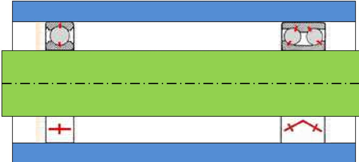
Figure 5 : Schéma du guidage (avec les directions des normales au contact)
